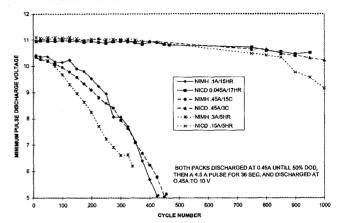
EFFECT CYCLE LIFE ON MID POINT DISCHARGE VOLTAGE
