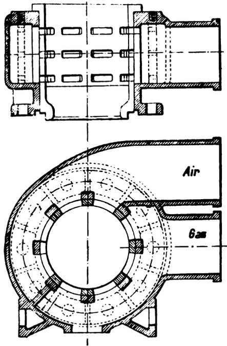
FIG. XI.—42. Elsassische Mixing Valve Box.
