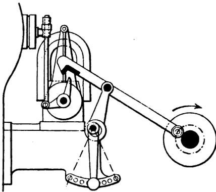
FIG. X.—13. Magneto mechanism,
