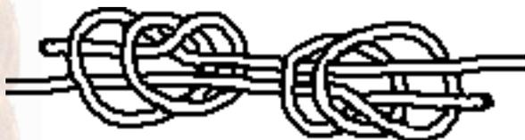
Dit is de dubbel-stopper knoop met als basis de [Dubbele Overhandknoop](#). Eigenlijk leg je twee [wurgknopen](#) om de staande einden van beide touwen. Het is het best om de knopen tegengesteld te leggen. Bij gelijke knopen is
