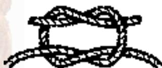
De platte knoop is slechts bruikbaar voor het eenvoudige werk. Hij is eenvoudig te leggen en beklemt zich niet waardoor hij altijd makkelijk los te krijgen is. De toepassingen variëren van het vastzetten van opgerolde zeilen, het dichtbinden van pakjes, tot de basis van de schoenstrik. Zijn naaste verwanten, het ouwe-wijf, de dievenknoop en de what-knoop hebben zo hun eigen toepassingen, maar die hebben niets met een betrouwbare verbinding te maken.
