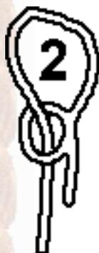
Bij de tweede manier knoop je een lopend oog rond het staande part, ( een simpele knoop of steek ) zodanig dat de lus sluit als aan het lopend eind getrokken wordt. Dit is de meest gebruikte manier om een schuifknoop te maken. Het zorgt ervoor dat de lus makkelijk sluit (maar vaak moeilijk opent.)
