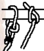
Dit is de "gekapseide" overhandknoop. Het is een bijzonder bruikbare steek om lichte lasten te dragen die snel los te maken moeten zijn. Ashley raadt hem aan voor het ophangen van voorraden buiten het bereik van muizen. Je moet hem echt met rust laten.
