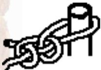
De twee halve steken worden gebruikt om een touw te knopen aan een ring of paal met een haakse belasting. Het moet constant belast blijven. (Hoeft niet onder een constante belasting.) Hij beknelt zich niet. Als het object een kleine diameter heeft is het verstandig om een extra rotorn te nemen.
