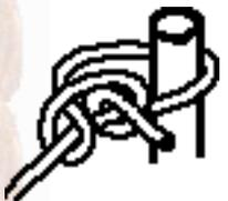
De "Buntlijn" steek werd gebruikt om de "buntlijn" van een vierkant getuigd schip vast te zetten. Het is een veilige knoop, maar heeft nijing zich te beknellen. Hij is daarom niet eenvoudig los te krijgen. Daarom is hij geschikt voor werk dat langer zonder toezicht gelaten moet kunnen blijven.
