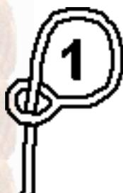
Er zijn drie basismethoden om een schuifknoop te maken. Bij de eerste wordt het staande part door een vast oog aan het einde van het touw genomen. Dit kan een ingesplitst oog zijn maar ook een geknoopte zoals de paalsteek. (De [paalsteek](#) wordt feitelijk veel door zeilers als lopend-oog gebruikt.) Ook de enkelvoudige schuifknoop zelf wordt wel gebruikt als soepel lopend-oog.
